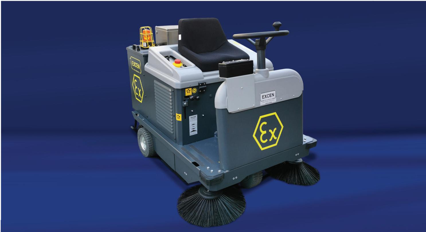
**Balayeuse haute performance à conducteur porté**, facile à utiliser pour fonctionner dans des **zones potentiellement explosives** en raison de la présence de gaz, de vapeurs et/ou de poussières combustibles, est idéale pour le nettoyage de grandes surfaces.
